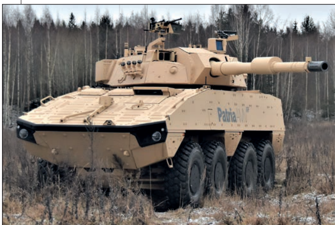
■ Na platformě Patria AMV XP jsou integrovány a otestovány zbraňové stanice až do tankové ráže 120 mm nebo hlavnový minomet Patria NEMO 120 mm.
