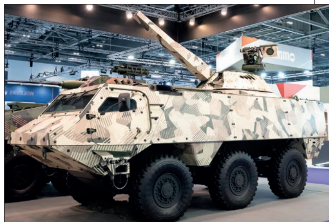
■ Na platformě Patria AMV XP jsou integrovány a otestovány zbraňové stanice až do tankové ráže 120 mm nebo hlavnový minomet Patria NEMO 120 mm.
